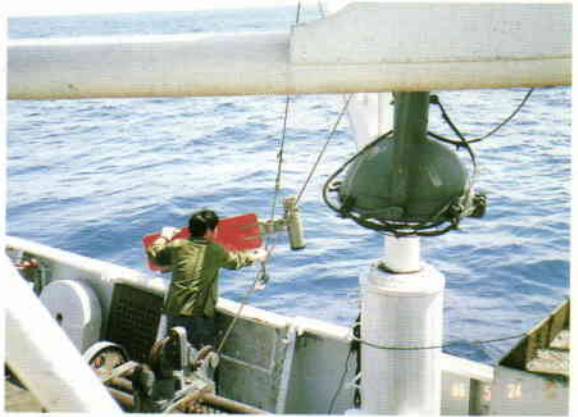
▲流速計の設置作業
