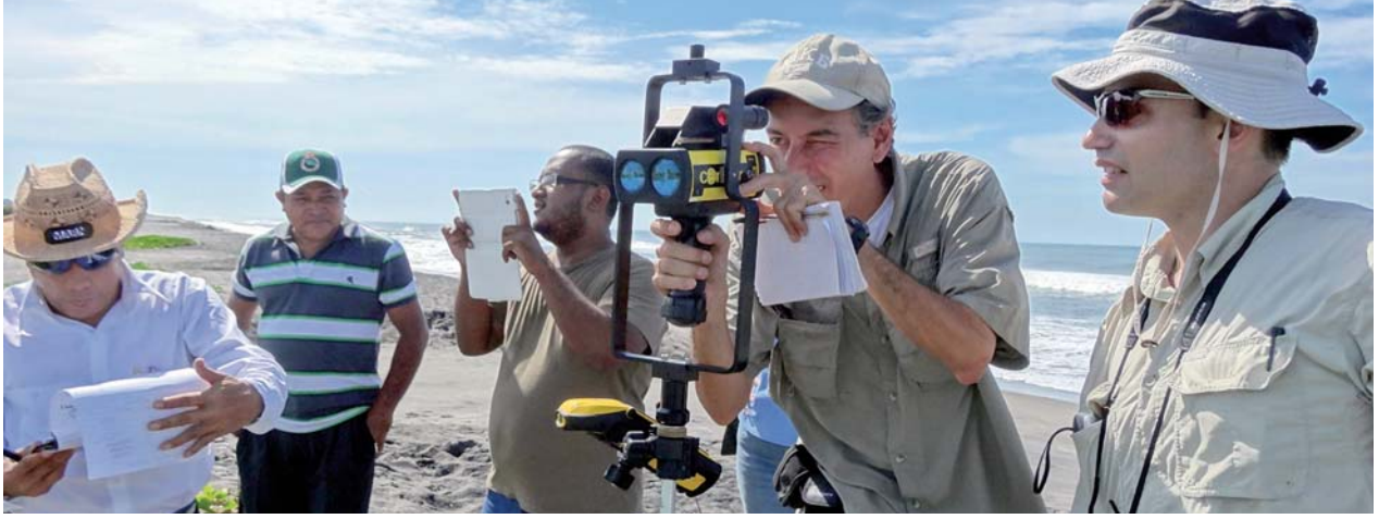
الفريق الدولي للدراسات الاستقصائية في مجال أمواج التسونامي يقيس اعتلاء أمواج التسونامي بواسطة جهاز ليزري لتحديد المدى في سلفادور عام ٢٠١٢. تُستخدم هذه الصورة بإذن من المركز الدولي للإعلام عن أمواج التسونامي (ITIC).
