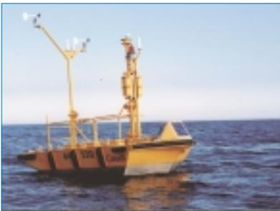
*Le Groupe de coopération pour les programmes de bouées de mesure coordonne la mise à l'eau et l'exploitation des bouées ancrées et dérivantes servant à recueillir des données.*
