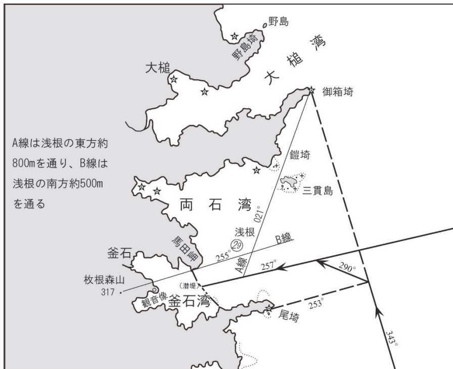
第18図 釜石湾入港針路法及び浅根避険線図【図の差し替え】
