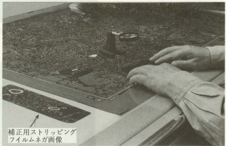
写真3 海図原版(ネガフィルム)に補正用ストリッピングフィルムネガ画像の貼り込み
