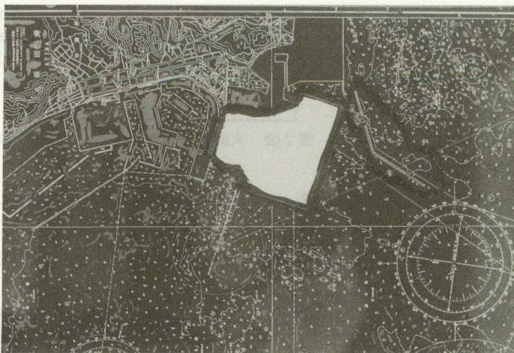
写真5 海図原版(ネガフィルム)の大面积補正箇所の銀画像削除
