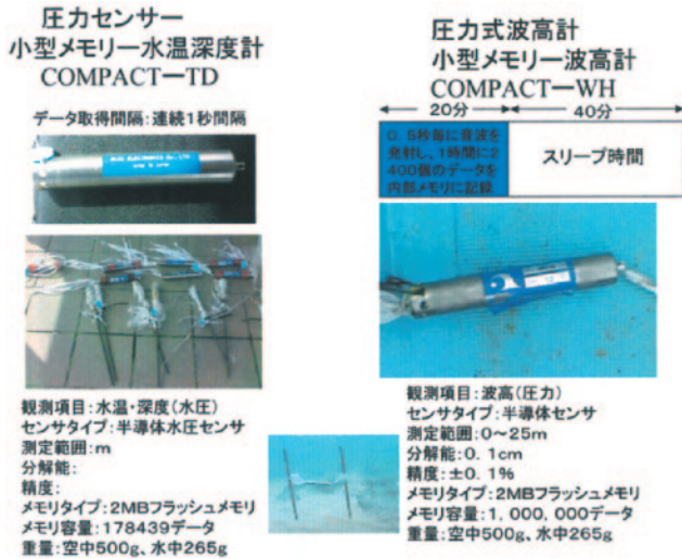
第4図 圧力センサーと圧力式波高計 Fig. 4 Pressure sensor and hydraulic-pressure-type wave height meter.
