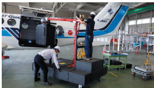
Photo 6. Ground service equipment for CZMIL Nova. 写真 6. 航空レーザー測深機取付具.
