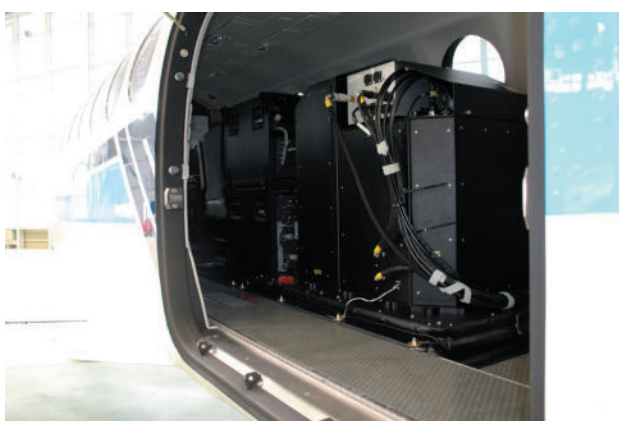
Photo 7. Installation condition of CZMIL Nova (viewed from the tail). 写真 7. CZMIL Nova の設置状況（機尾側から見た写真）.
