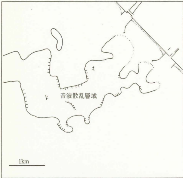
第6図 深層音波探査によって検出された音響反射面の不連続のトレースと、表層音波探査における音波散乱層の分布域。ケバをつけた線はマルチチャンネル音波探査において反射面のずれが認められたところ。
