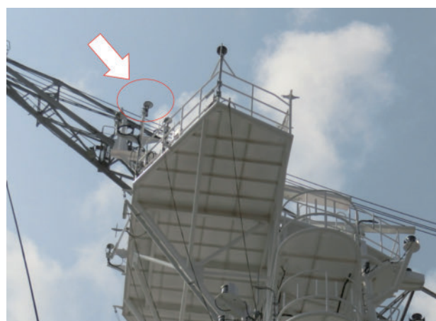
Photo 5. GNSS antenna installed on the mast of the S/V Heiyo. 写真5. 「平洋」マスト部分に設置されたGNSSアンテナ.
