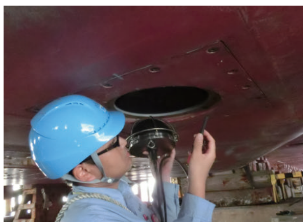
Photo 2. Verification of acoustic transducer mounted on the hull of the S/V Heiyo. 写真2. 「平洋」船底に設置された送受波器の動作確認.
